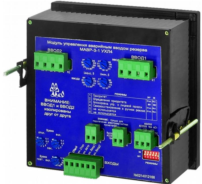
Модуль автоматического ввода резерва МАВР-3-1 (далее модуль) представляет собой устройство управления, предназначенное для автоматического переключения на резервную линию при неисправности или отключении рабочей линии. Устройство предназначено для работы в составе шкафов (блоков) управления автоматическим включением резервного питания в системах бесперебойного электроснабжения 3-х фазных электроприёмников I и II категории подключения согласно требованиям ПУЭ.
